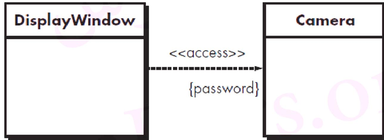
`<<access>>` به این معنی است که استفاده از خروجی دوربین توسط یک کلمه عبور خاص کنترل می شود.
